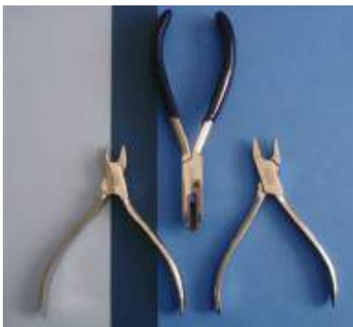
**Figura 5.161.** Pinzas de corte, de dos y tres picos.
